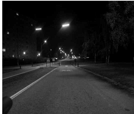
Figur 2 Övergångsställe N2, Hagebygatan, Norrköping. Extrabelyst med lysrör.
