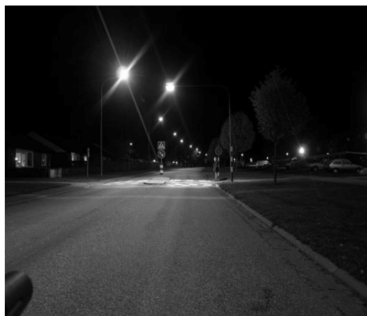
Figur 5 Övergångsställe M1, Gustavsviksvägen, Motala. Asymmetrisk intensivbelysning.
